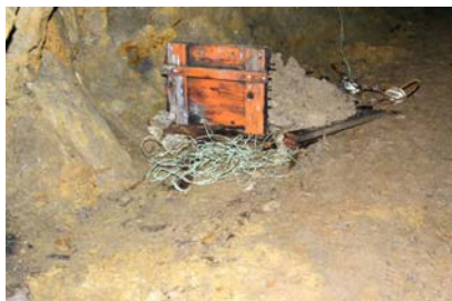
... jinde s jilem na ucpávky (šulky) vývrtů pro střelné práce...
