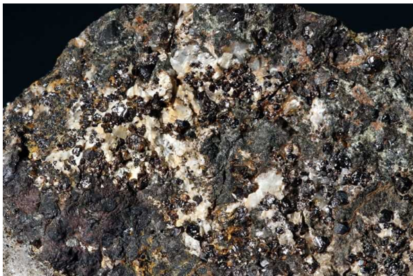
vlevo vzorek skarnu s magnetitem, maghemitem a kassiteritem, vpravo detail se zrnky kassiteritu (halda Vladimír, Jáchymov, 2002)
