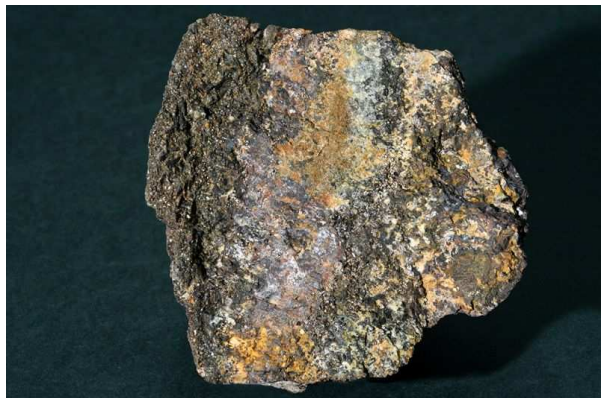
vlevo vzorek skarnu s magnetitem, maghemitem a kassiteritem, vpravo detail se zrnky kassiteritu (halda Vladimír, Jáchymov, 2002)
