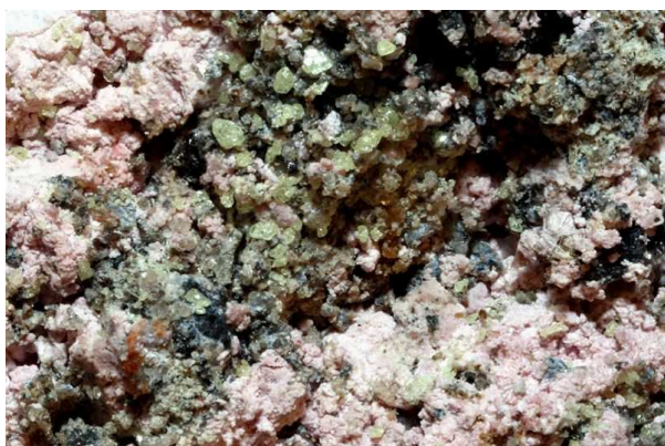
relativně rychle, opět během fotografování, ztratí vodu např. melanterit (zelená skalice), kdy se modravě zelenavé a průhledné agregáty změní v křídově bílé a neprůhledné agregáty rozenitu (Jáchymov-Svornost, žíla Geschieber, 1992)
