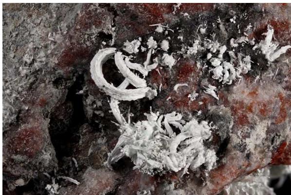
relativně rychle, opět během fotografování, ztratí vodu např. melanterit (zelená skalice), kdy se modravě zelenavé a průhledné agregáty změní v křídově bílé a neprůhledné agregáty rozenitu (Jáchymov-Svornost, žíla Geschieber, 1992)
